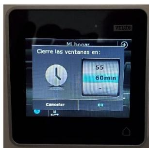
Il y a deux télécommandes, l'une montée dans la chambre et l'autre dans la salle de bain, qui fonctionnent toutes les deux de la même manière. L'une ou l'autre télécommande peut ouvrir et fermer l'un ou l'autre des puits de lumière automatiques, et vous pouvez même ouvrir et fermer les deux avec la même commande.
